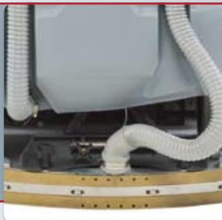
Il sistema terqipavimento con gomme brevettate ottimizza il flusso in aspirazione garantendo una asciugatura perfetta
